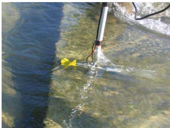
Mulinello impiegato per le misure correntometriche
