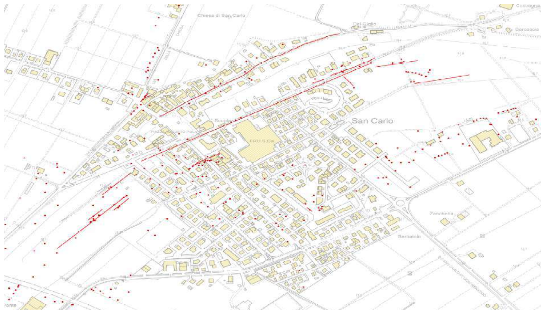
Effetti della liquefazione osservati a S. Carlo.
